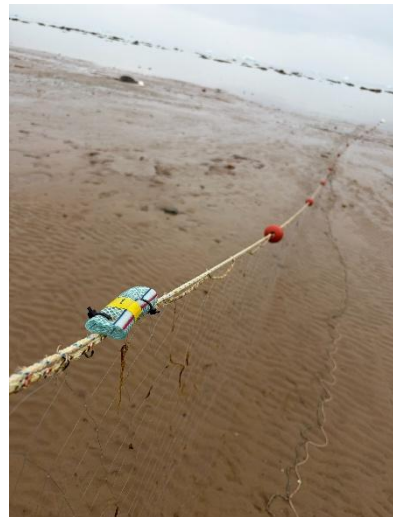
図 2. 刺網に取り付けたセンサー
