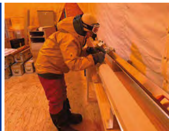
ドームふじ観測拠点IIにてアイスコアの深度を決めている風景。 画像右手前がアイスコア。
